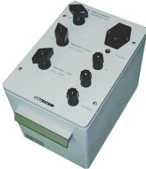
Этот трансформатор тока с электронным управлением специально предназначен для расширения диапазона тока при измерениях емкости.
