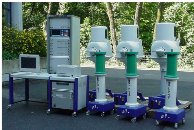
Система измерения потерь силовых трансформаторов типа TMS 580 580-100-4000
