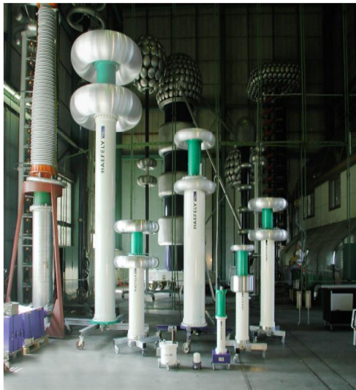
Образцовые конденсаторы семейства от 5 кВ до 800 кВ компании Haefely Test AG
