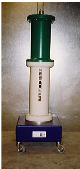
Образцовый конденсатор на 100 кВ
